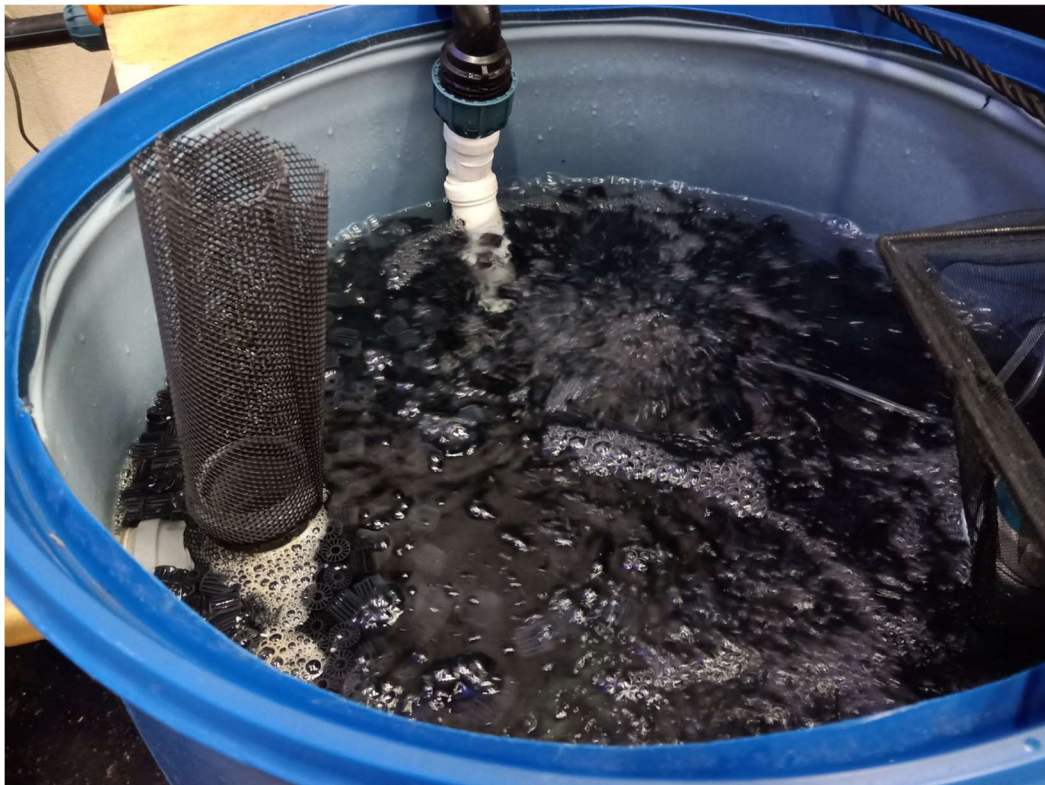
Joonis 11. Biofilter biokilekandjaga
