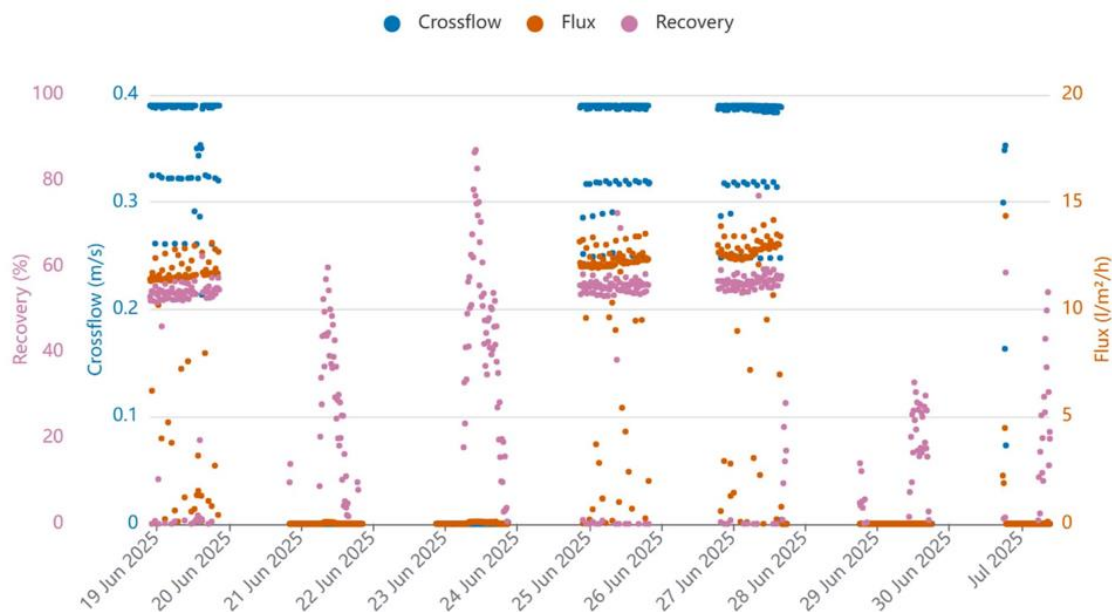
Joonis 15. Pilootseadme opereerimisandmed nanofiltrimise ajal.
