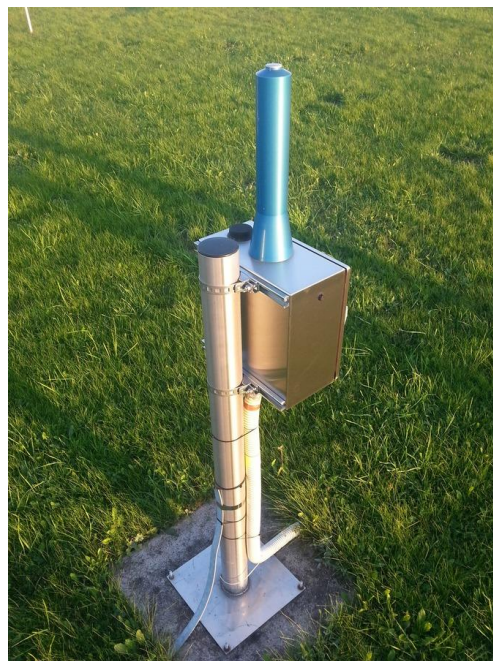
Gammakiirguse taset mõõtev gamma-spektromeetriline seirejaam
