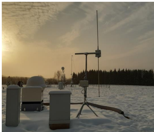
Eksperimentaalne ülimadalsageduslik pikamaa välgudetektor LEELA
